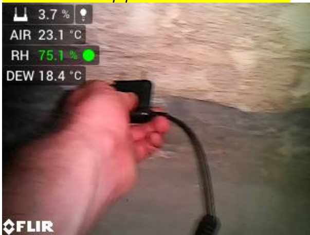
foto 33 0.04 kotelna vlhkost 3,7 % hm
