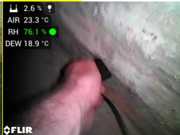
foto 34 0.04 kotelna vlhkost 2,6 % hm
