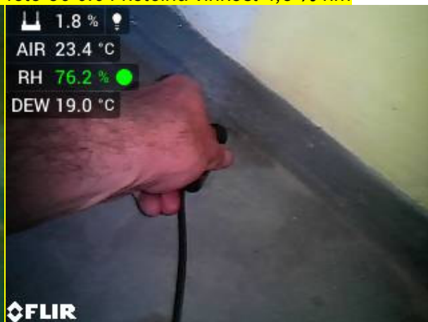
foto 37 0.04 kotelna podlaha vlhkost 4,1 % hm foto 38 0.04 kotelna podlaha vlhkost 1,8 % hm
