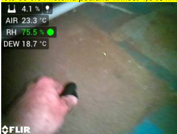
foto 37 0.04 kotelna podlaha vlhkost 4,1 % hm foto 38 0.04 kotelna podlaha vlhkost 1,8 % hm
