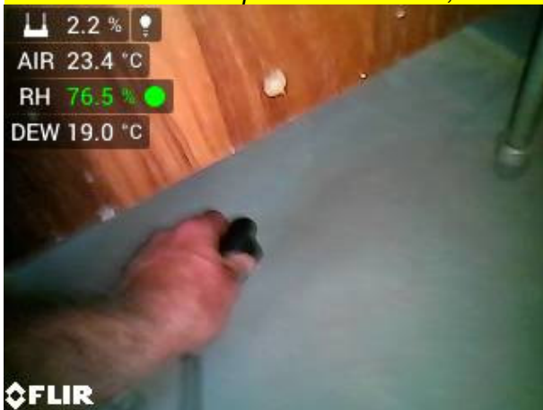
foto 39 0.04 kotelna vlhkost podlaha 2,2 % hm foto 40 0.05 dílna
