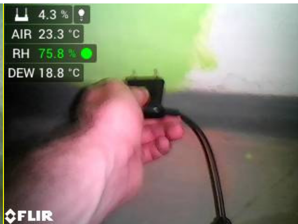
foto 35 0.04 kotelna podlaha vlhkost 4,8 % hm foto 36 0.04 kotelna vlhkost 4,3 % hm
