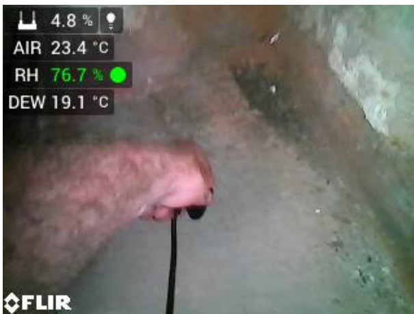
foto 35 0.04 kotelna podlaha vlhkost 4,8 % hm foto 36 0.04 kotelna vlhkost 4,3 % hm
